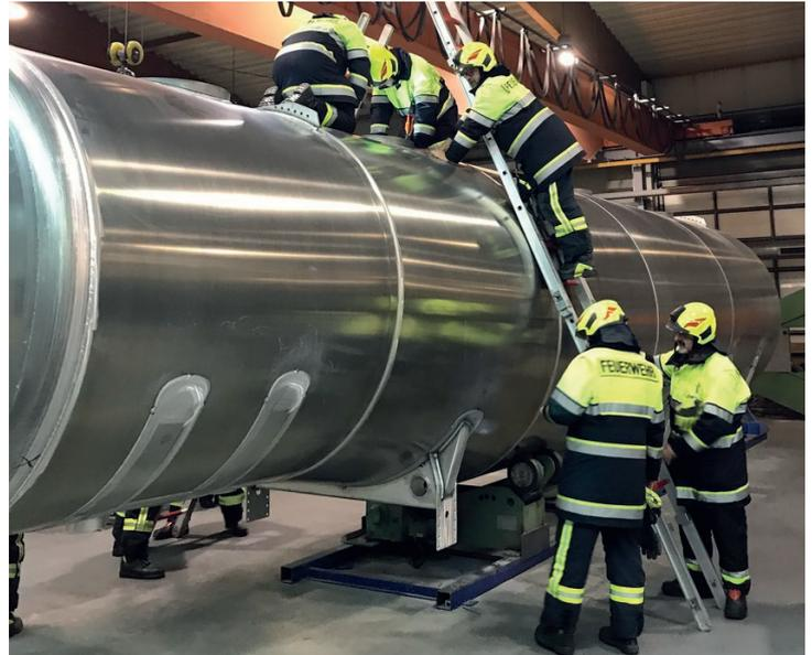
Ausstieg durch die Mannlöcher des Tanks getestet. Ein weiterer Rettungsversuch erfolgte mit einem Bergegeschirr mit Hilfe des Krans von oben. Zudem wurde das Aufschneiden eines
